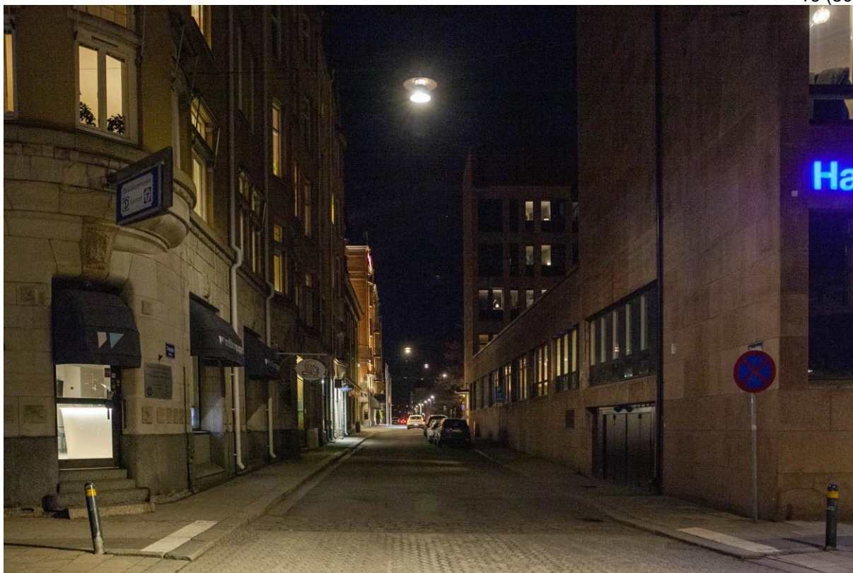
Bild 4. Om kontrasten är för hög mellan korsningen och gaturummet mellan korsningarna uppstår det ett mörkt parti som kan upplevas otryggt. Skillnaden i kontraster riskerar även att påverka trafiksäkerheten. Detta kan åtgärdas genom att dämpa ljuset vid korsningen och/eller komplettera med dämpad gatubelysning i passagen. Foto: Jonas Kjellander
