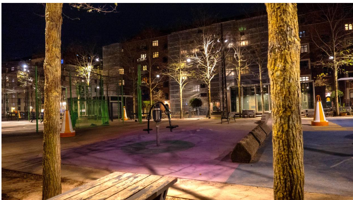
Bild 7. Jämför med bild 7. Allmänbelysning från linspänn lättar upp kontrasterna generellt. Strålkastare fokuserar på träden i stället för lekutrustningen. Det skapar skuggspel på marken och bidrar med vertikalljus som ramar in lekplatsen likt en ljus fond. Belysningslösningen bidrar till överblickbarhet, trygghet och minskad risk för bländning vid lekutrustningen. Foto: Tobias Olsson
