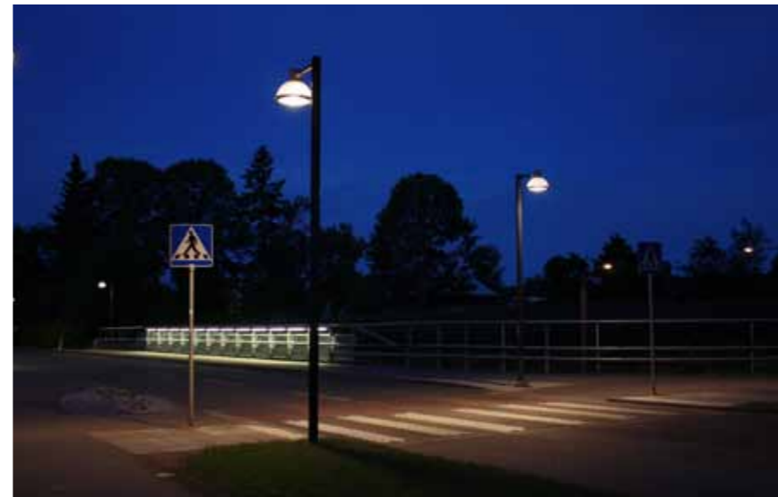
Övergångsställe enligt princip från Norrköpings kommun. Stolpe placerad bakom övergångsställe sett ur körriktning.
