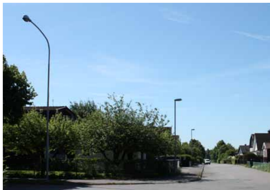
Den lägre stolpen berättar för trafikanten att det är en lugn villagata. Den höga stolpen med arm skulle lika gärna sitta på en stor huvudgata.
