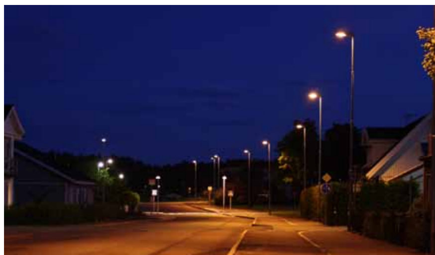
Enkelsidigt placerade stolpar utan stolparmar ger ett ordnat intryck. Utan att ta för stor plats visuellt bidrar de till enkel orientering.
